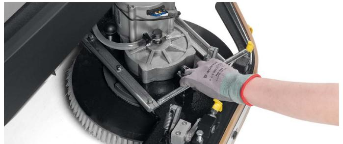
Basamento estraibile sul lato sinistro per facilitare l'ispezione e la sostituzione della spazzola di disco centrale.
