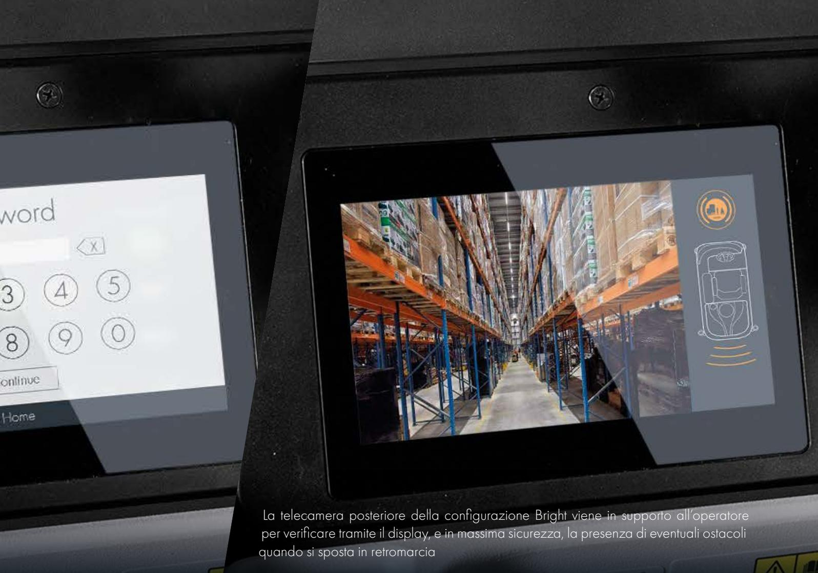
La telecamera posteriore della configurazione Bright viene in supporto all'operatore per verificare tramite il display, e in massima sicurezza, la presenza di eventuali ostacoli quando si sposta in retromarcia
